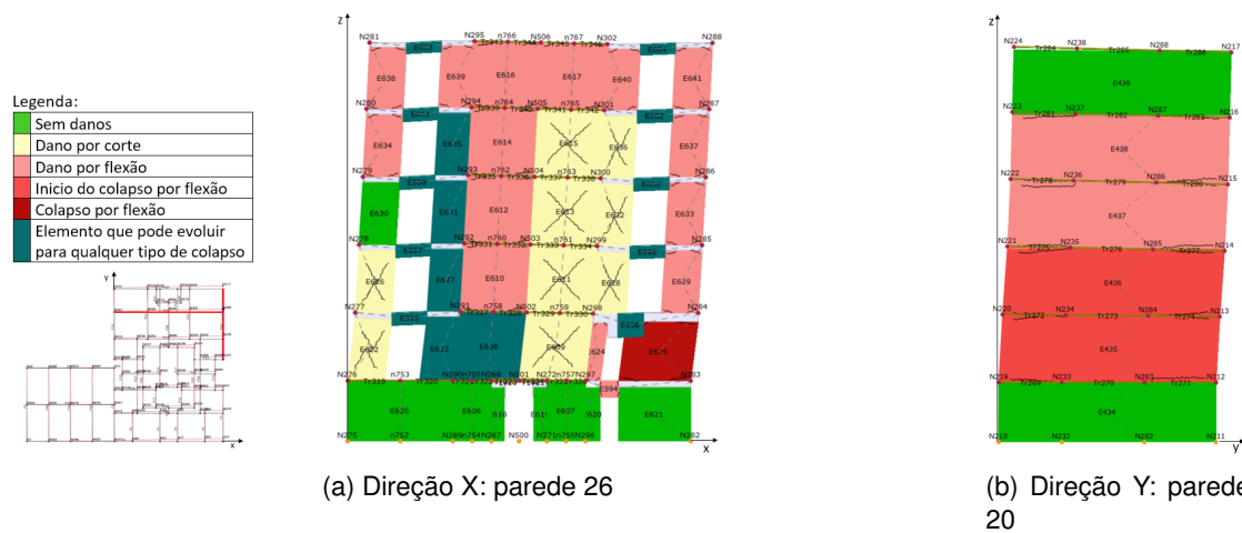
Figura 6.4: Padrões de dano após o reforço por injeção de cal para distribuição de força pseudo-triangular no sentido positivo
