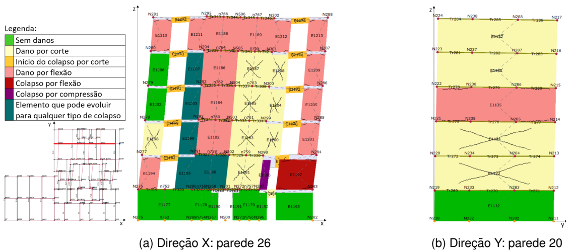
Figura 6.13: Padrões de dano após o reforço com sistema FRCM carbono para a distribuição pseudo-triangular sentido positivo
